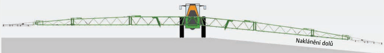
Naklánění ramen dolů (pomocí skládání Flex 2 v kombinaci se systémem ContourControl)
