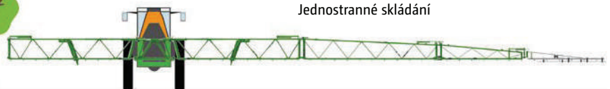
Jednostranné skládání ramen (pomocí skládání Flex 1)
