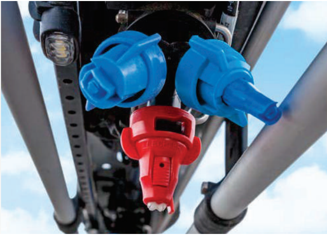
✔ Elektrické ovládání jednotlivých trysek AmaSwitch
