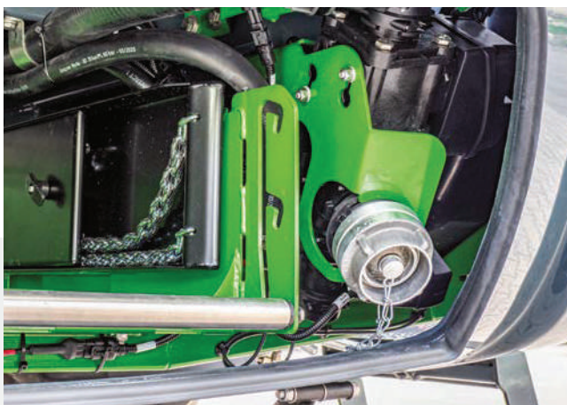
✔ Plnicí přípojka v odkládací schránce s automatickým zastavením plnění
