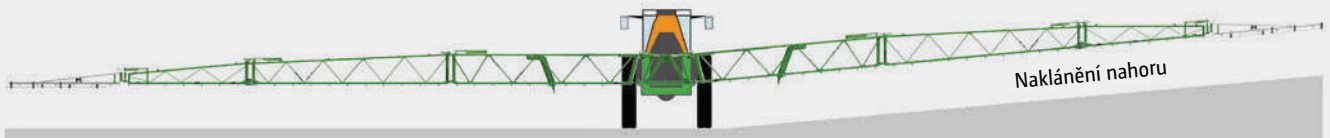
Naklánění ramen nahoru (pomocí skládání Flex 2)
